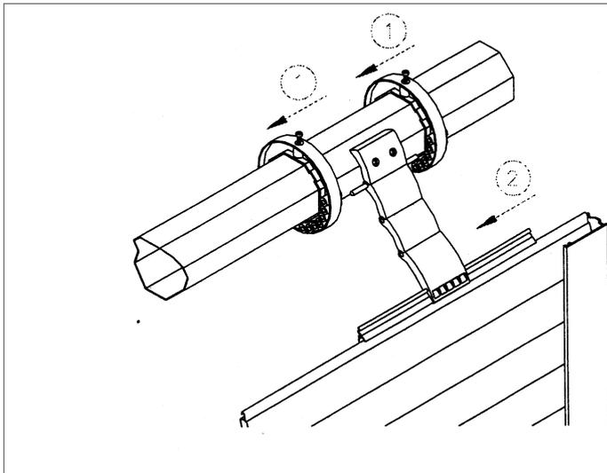
1 - Inserire i due anelli di fissaggio nel rullo. Gli anelli devono essere sincronizzati fra loro.
