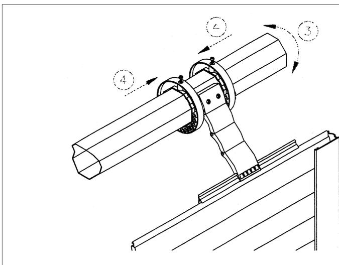
3 - Ruotare il rullo se necessario e fare coincidere i fori degli anelli con il perno dell'attacco (corpo centrale).
